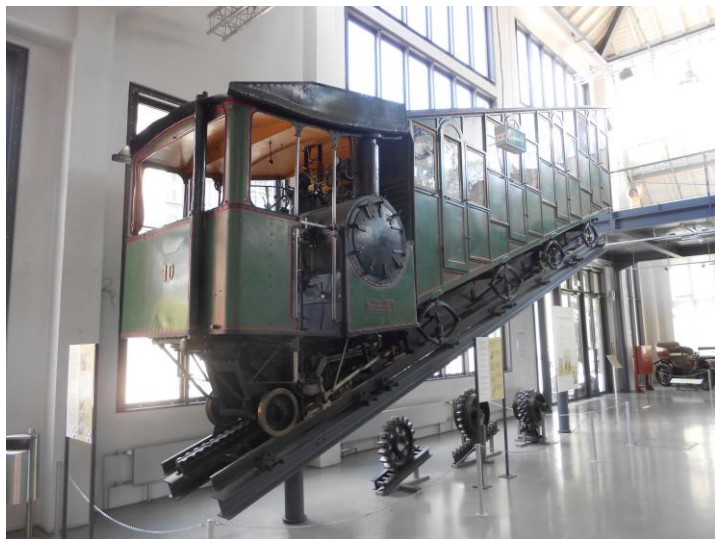
Dampmotorvogn fra Pilatus-banen i Schweiz. Kedlen står på tværs, så den ene ende ikke bliver tørlagt på stigningen på 48 promille.
